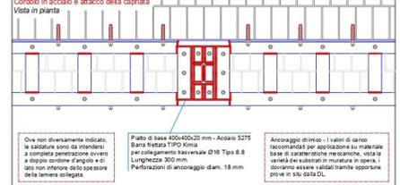
Due non diversamente indicati, le saldature sono da intercedere a completa penetrazione ovvero a doppia sezione d'angolo e di lato non inferiore dello spessore della lamina collegata.
